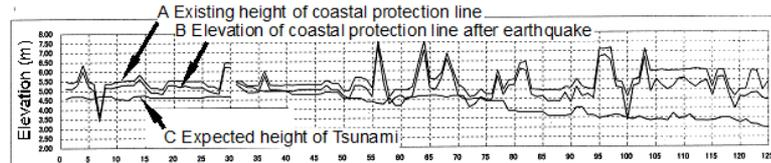
堤防の沈下予測(技術開発の動向)
