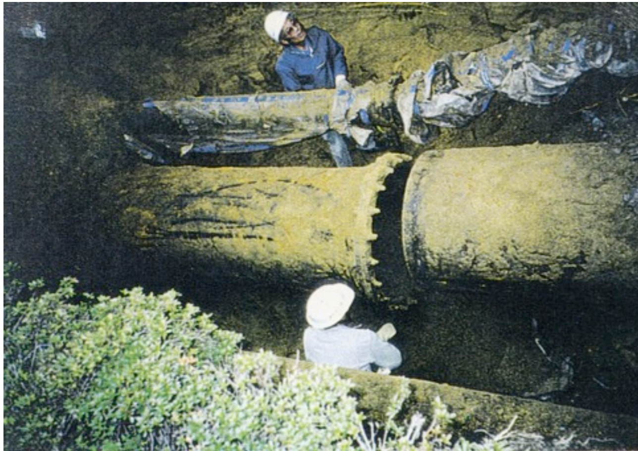
Φ800mm DIP継手の離脱（神戸市水道局）
