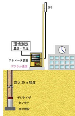
図4 MeSO-net 観測点の構成。主に小中学校の校庭に20mの観測井を掘って設置しました。
