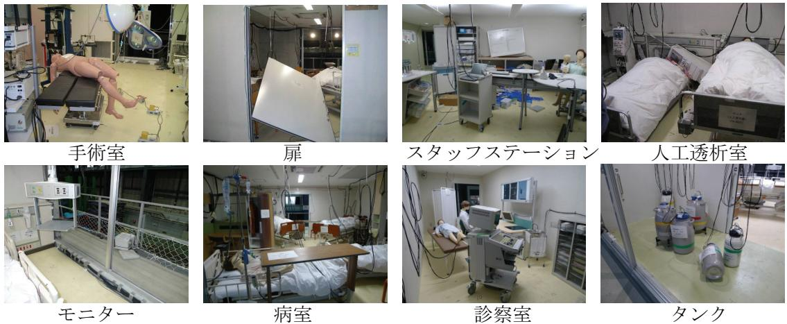
写真2 耐震構造における短周期地震波加振後の室内状況
