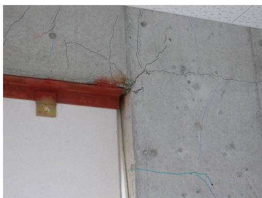
写真1 試験体に発生したクラック
