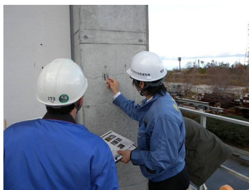
写真1 試験体に発生したクラック
