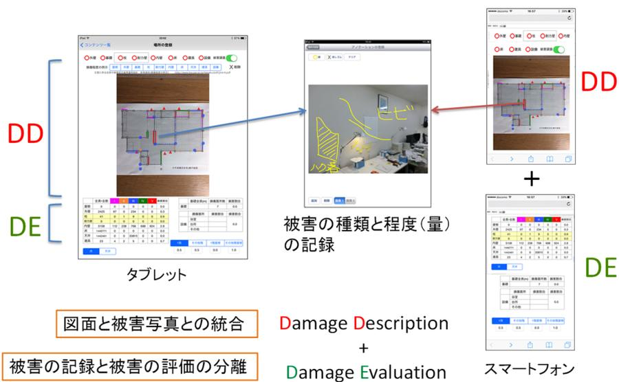
図4 タブレット端末とスマートフォンによる建物被害調査アプリの設計
