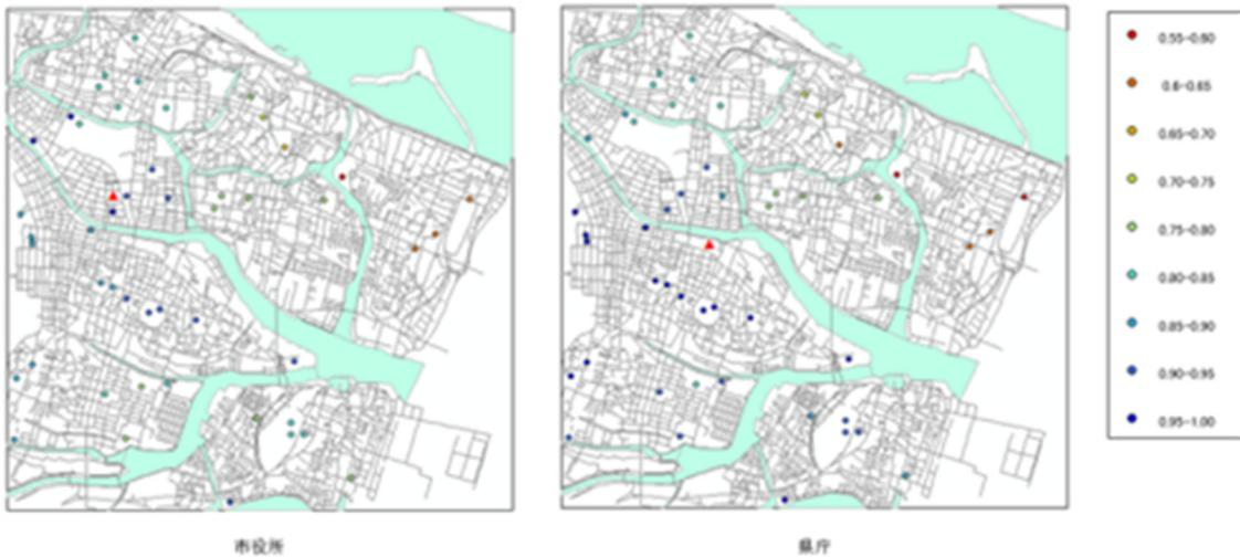
図 15 津波災害時における道路ネットワークの機能支障評価から得られた避難所のハザードマップ
