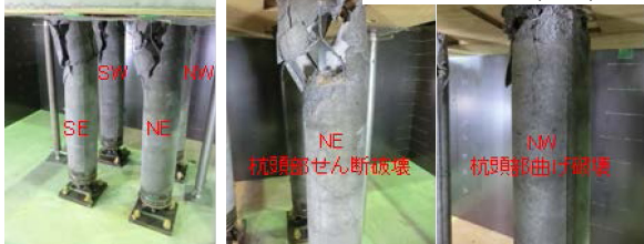
写真2 加力終了後の杭の破壊状況(杭頭部)
