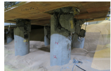
図14 予備実験の試験体概要 図15 杭-地盤系の荷重-変形関係 図16 連成系加振での破壊状況
