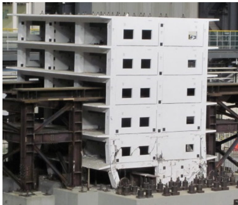
鉄筋コンクリート造建物の崩壊実験
