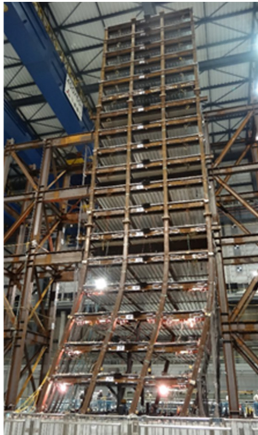
超高層鉄骨造建物の崩壊実験
