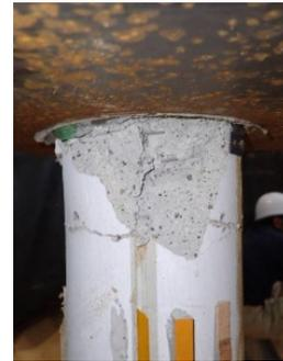
図 12 杭頭部のモルタル圧壊状況
